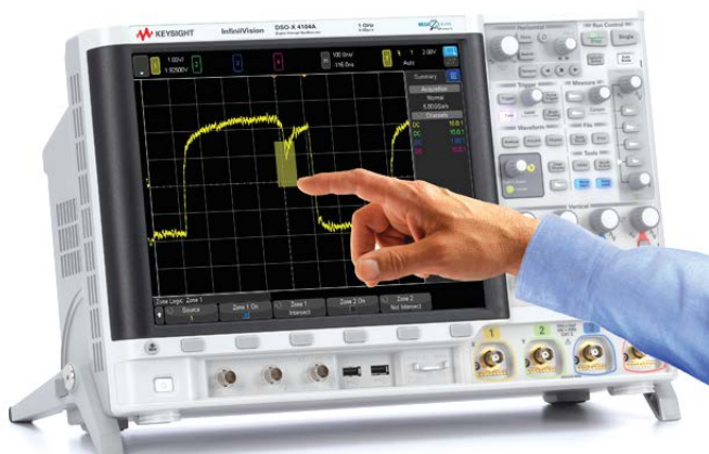
Рис. 12. Самый большой в отрасли емкостной сенсорный дисплей с диагональю 30,7 см (12,1 дюйма) с крупными, удобными для касания элементами управления.
