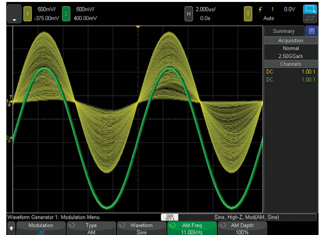
Рис. 22. Созданный с помощью WaveGen выходной синусоидальный сигнал с амплитудной модуляцией и без модуляции.
